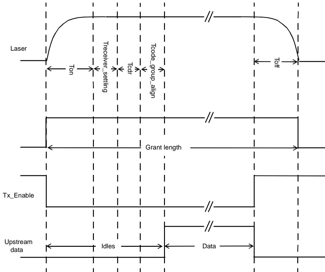
**Figure 60-7—P2MP timing parameter definition**
